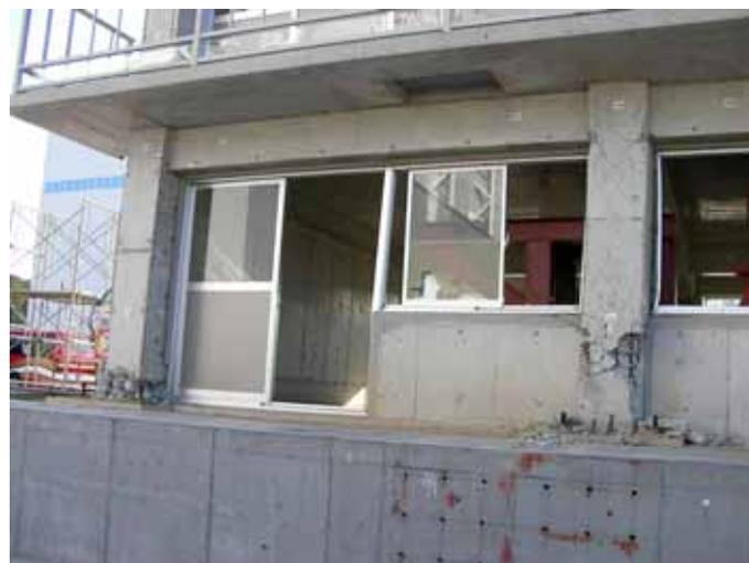
前回（無補強）9月の実験状況基礎を振動台に剛結した実験後で柱の圧縮破壊が見られる。
